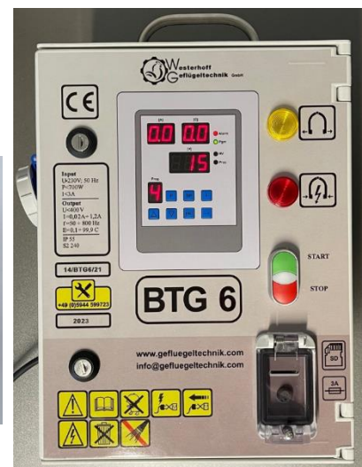
Typ BTG 6 Fa. Westerhoff Geflügeltechnik, der Kopf wird von unten in die V-förmige Elektrode eingeführt
